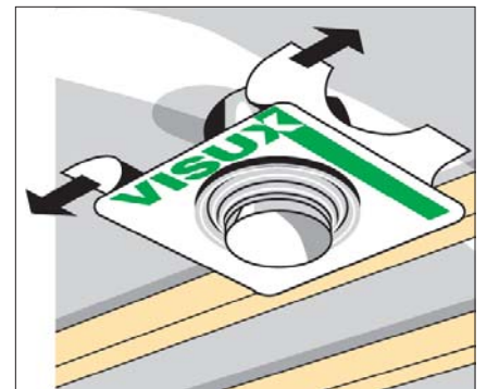
2. Puhdista putken ympäristö huolellisesti pölystä, rasvasta ja muusta liasta. Käytä tarvittaessa esim. spriitä (auton jäänestoainetta).
